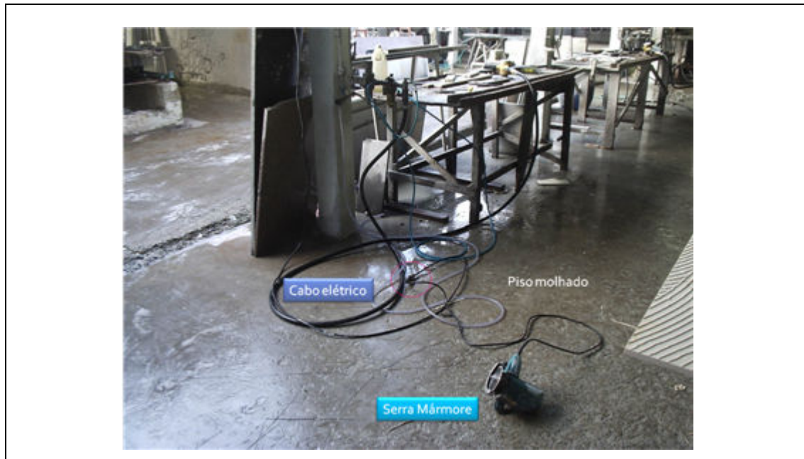
Figura 11 - Riscos de acidentes. Fonte: O autor
