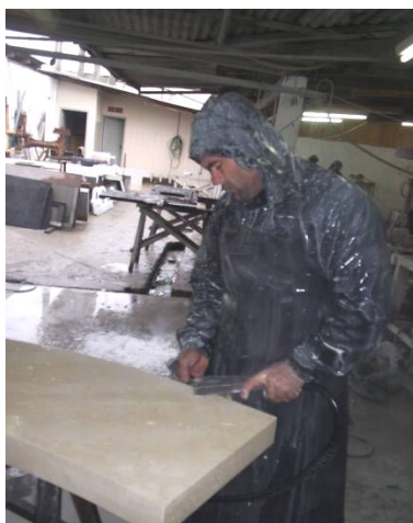
Figura 6 - Marmorista usando proteção contra umidade e barreira de madeira improvisada.
